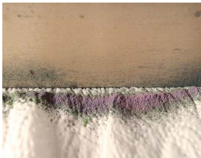
Der Pigmentstaub fällt nach unten auf ein feuchtes Tuch und sammelt sich dort. Durch die Feuchtigkeit wird er leicht gebunden und kann nicht mehr stauben.
